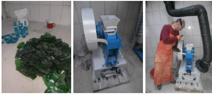
Toplama hazır cam şişler, cevher kırma makinesi ve makinede kırma eylemi.
